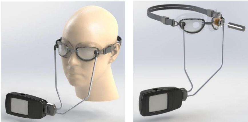
2.1.7 pav. MPD modelis ir jo modifikuota versija. Akinių lęšiuose yra prieiga, leidžianti atlikti pneumatometrinius matavimus neigiamo slėgio metu (adaptuota iš [83])
