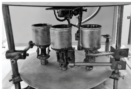
2.1.3 pav. a) magnetroninės sistemos nuotrauka; b) magnetroninės sistemos schematinis vaizdas (1 – platinizuotas silicio pagrindas, 2 – kaitinimo elementas, 3 – padėklo judėjimo kryptis, 4 – katodai, 5 – aušinimo sistema, 6 – nuolatinės įtampos maitinimo šaltinis)
