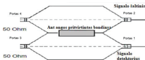
1.18 pav. Dviguba TEM elementų EML SE matavimo schema [257]
