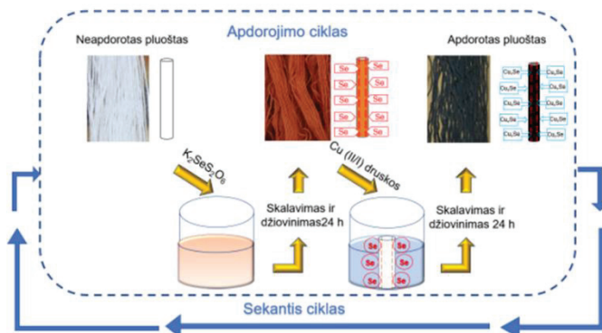
2.1 pav. Bandiniams modifikuoti vario selenidais naudoto dviejų pakopų sorbcijos-difuzijos metodo schema
