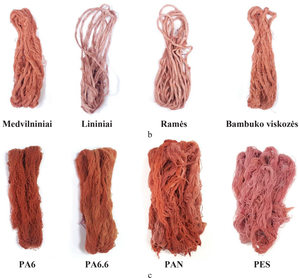
3.1 pav. Skirtingos prigimties pluoštų verpalų ir siūlų spalvos pokytis po pirmojo įseleninimo etapo: a – baltyminių, b – celiuliozinių, c – sintetinių
