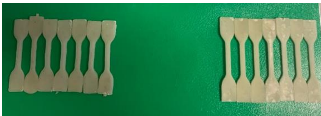
24 pav. Injekcinio liejimo būdu suformuoti bandiniai: kairėje triacetinas, dešinėje polietilenglikolis 200
