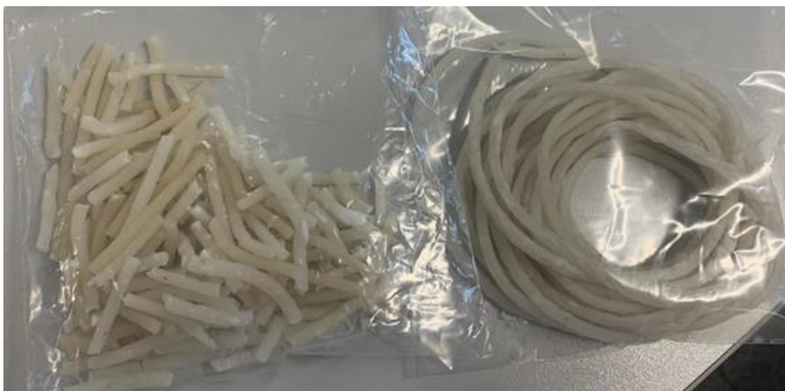
21 pav. Ekstruduoto krakmolo dodecenilsukcinato acetato gijos: dešinėje naudotas plastifikatorius triacetinas, kairėje – PEG200
