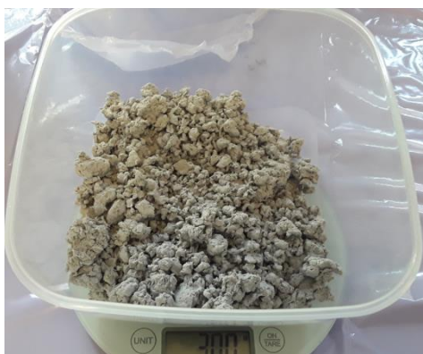
9 pav. Nusausinto dumblo tyrimui suformuotas mėginys
