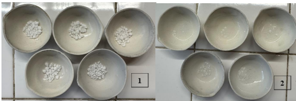
2.13 pav. Granulioto MAP + Zn nuotraukos: 2 – virš sotos NaNO 2 tirpalo, 1 – virš vandens
