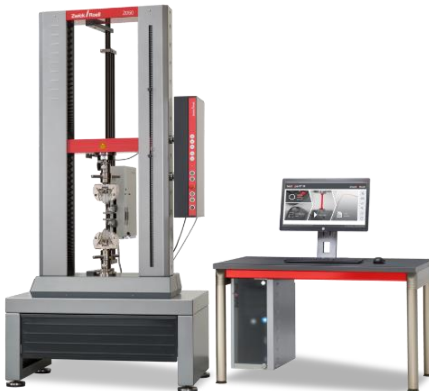
18 pav. „ZwickRoell“ „Z010“ Prietaisas standumo nustatymui [31]
