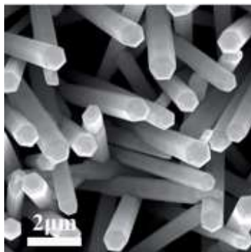
1.5 pav. Cinko oksidų nanovamzdelių struktūra [14]
