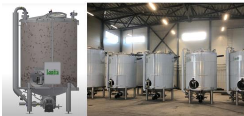
3.5 pav. Terminio apdorojimo (pasterizavimo) sistema, skirta patogenų sunaikinimui biomasėje, pvz. „BioChop Hygenisation System (Landia)“ 1
