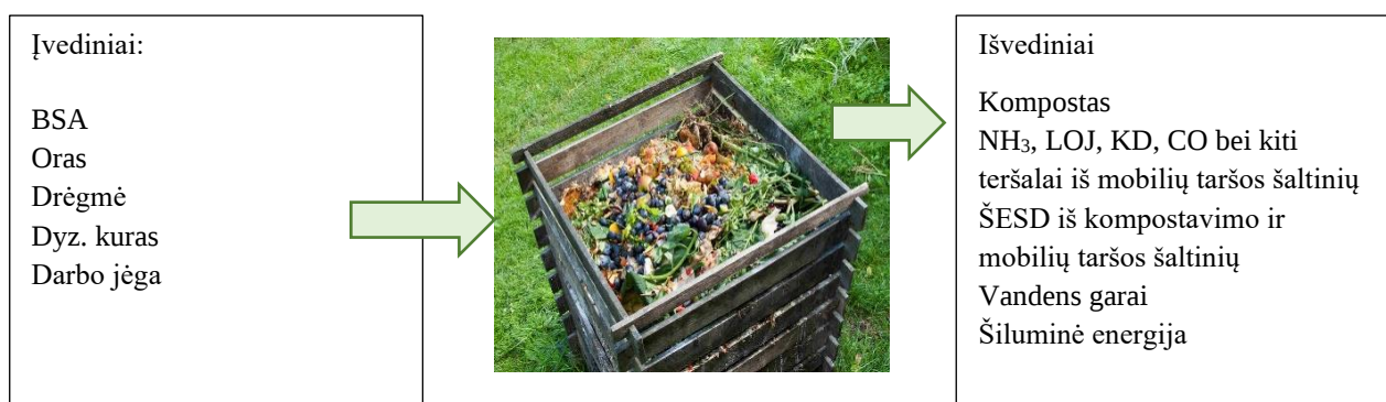
1.3 pav. Biologiškai skaidžių atliekų klasikinio kompostavimo proceso principinė schema
