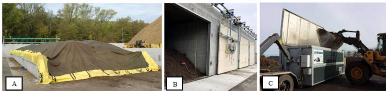
1.4 pav. Biologiškai skaidžių atliekų kompostavimo būdai (A – kompostavimas po plėvele B – tunelinė kompostavimo sistema; C – konteinerinė kompostavimo sistema) 1,2
