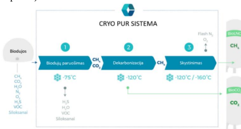
3.9 pav. Kriogeninio biodujų valymo, gryninimo ir skystinimo proceso principinė schema 1
