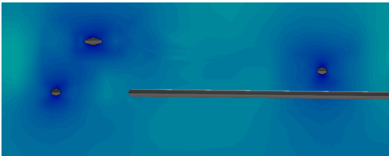
36 pav. Greičio pasiskirstymas skerspjūviniame kontūre, aptenkant nano gijas esančias filtro viduriniame sluoksnyje, kai aukščiausia riba greičio skalėje 1 cm/s
