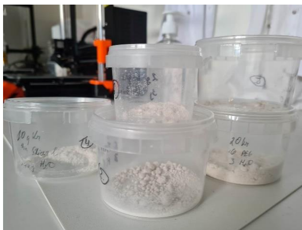
3.17 pav. Mišiniai Nr.1-Nr.6 filamentų gamybai
