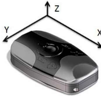
5 pav. „Bittium Faros 180” akcelerometro ašių išsidėstymas
