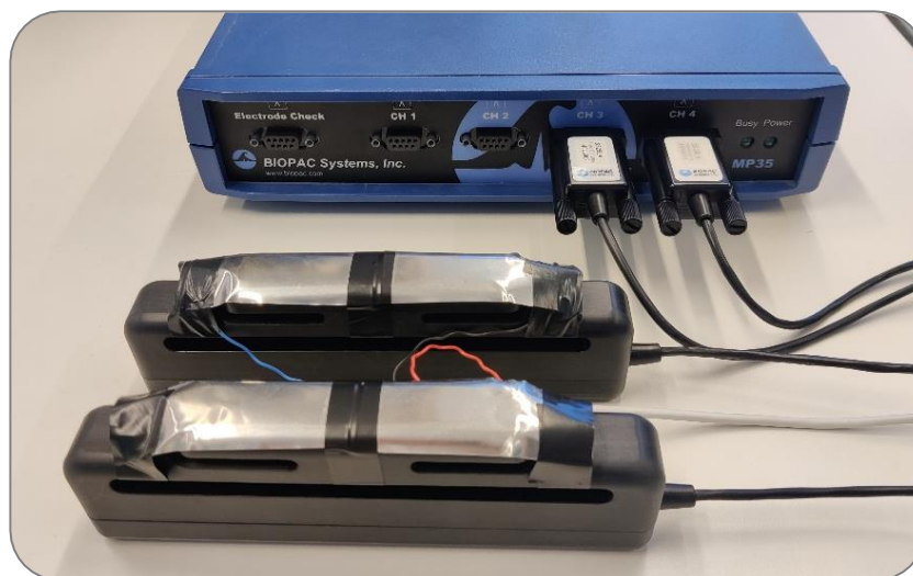
10 pav. Eksperimente naudota signalų registravimo sistema ir rankiniai dinamometrai su pritvirtintais elektrodais
