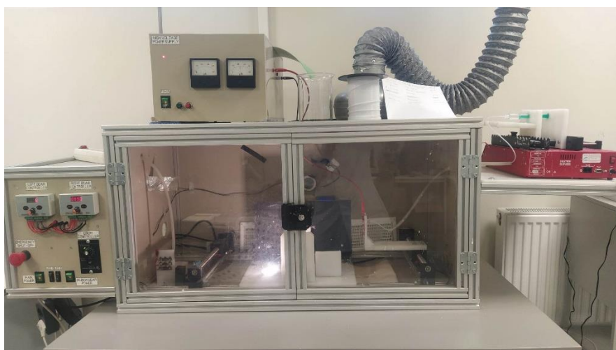
2.2 pav. Tirpalo elektrinio verpimo stendas
