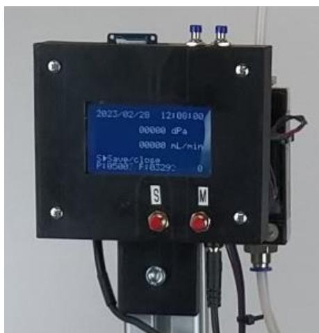
2.7 pav. Kapiliarinio srauto porometro valdymo blokas
