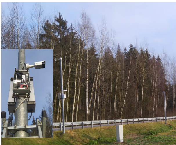
16 pav. Pagrindinio sistemos prietaisų bloko, pritaisyto prie stulpo, vaizdas
