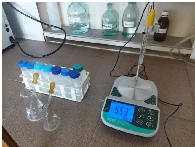
6 pav. Mėginių pH nustatymas pH metru ir jų paruošimas ICP–OES analizei
