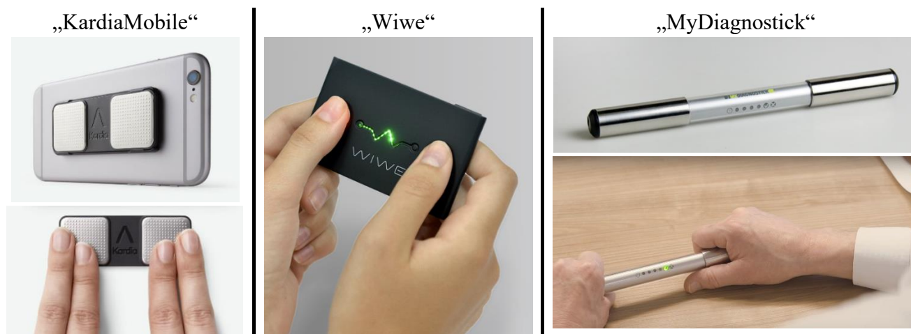
4 pav. Nešiojami pirštų elektrokardiogramos registratoriai (pritaikyta iš [34], [35], [36], [37])
