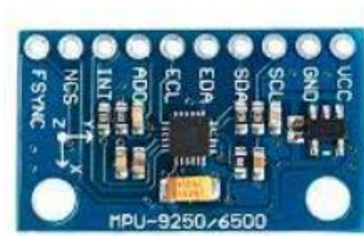
8 pav. MPU–9250 inercinio matavimo prietaisas, turintis 3 ašių magnetometrą ir naudotas magnetiniam laukui registruoti
