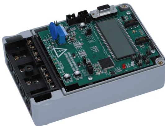
9 pav. EVM430-F6736 įvertinimo rinkinys [20]
