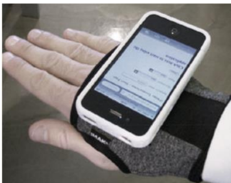
6 pav. Tremoro kvantavimo tyrimas mobiliuoju telefonu ir specialia pirštine [24]
