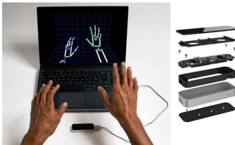
1.8 pav. Leap Motion Controller naudojimo pavyzdys ir jį sudarantys elementai [R9]
