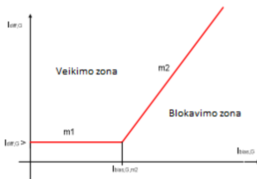
12 pav. Nulinės sekos srovė diferencinės apsaugos dviejų nuolydžių charakteristika
