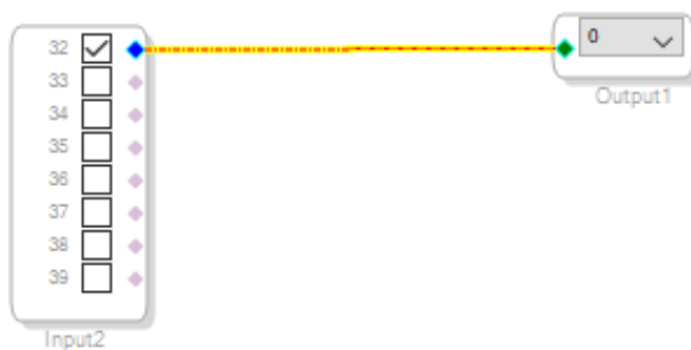
31 pav. DSP apėjimo blokinė diagrama
