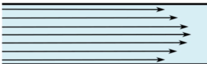
3 pav. Laminarinio tekėjimo pasiskirstymas vamzdelio skerspjūvyje [20]
