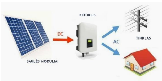
5 pav. Į elektros tinklą jungiamos saulės elektrinės schema [21]
