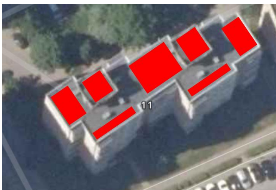
19 pav. Nagrinėjamo pastato stogo įvertinimas saulės elektrinių montavimui.
