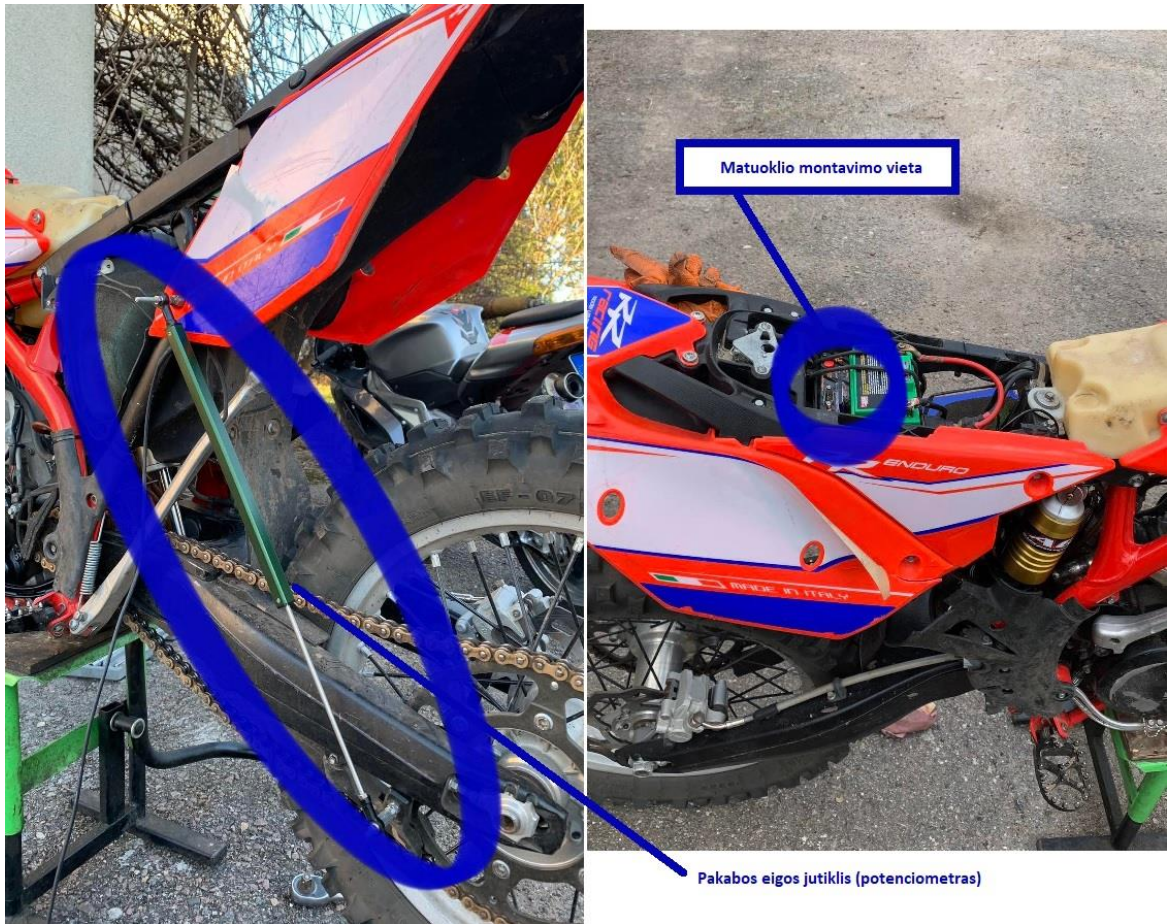
40 pav. Matavimo įranga pažymėta mėlynai bei jos montavimo vietos
