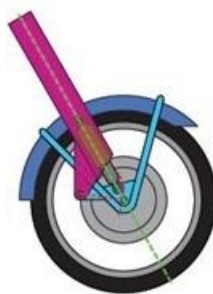
3 pav. Priekinė motociklo pakaba su svirtimi ir lankstu už priekinio rato ašies [7]
