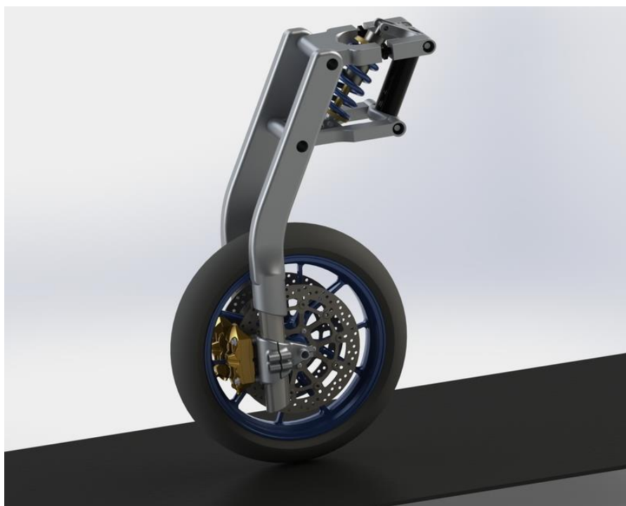
4 pav. Pakabos sistema su dviem svirtimis [8]
