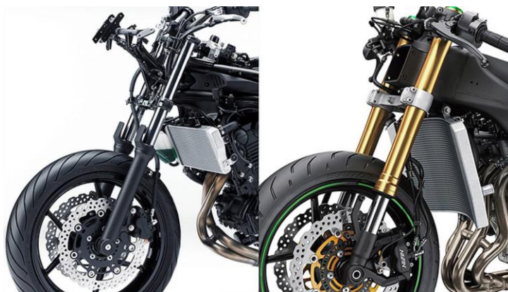
1 pav. Tradicinių ir apverstų šakių pavyzdžiai [6]
