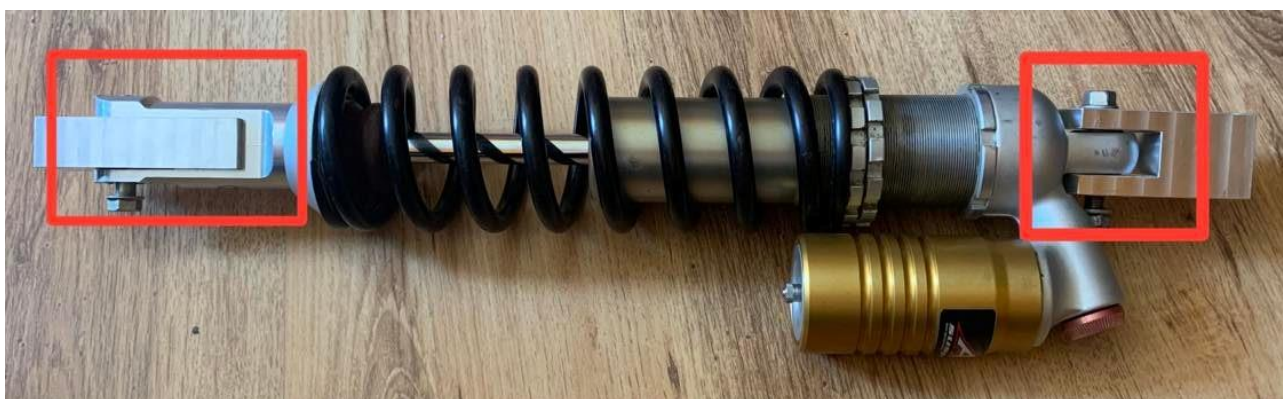
21 pav. Slopintuvas su sumontuotais tvirtinimais pažymėtais raudonai [asmeninis archyvas]
