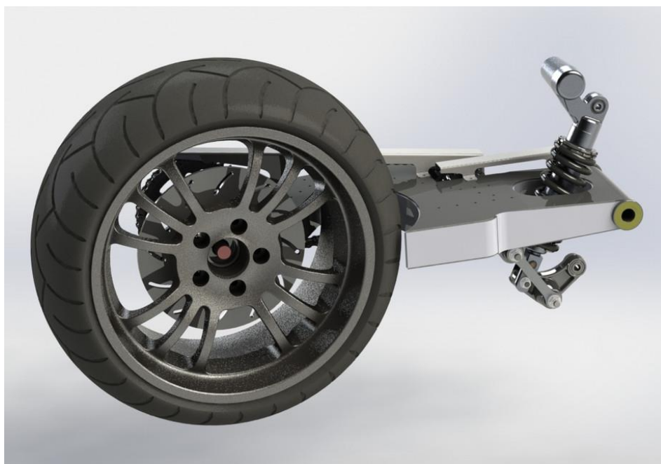
6 pav. Vienpusės svirties pavyzdys [10]
