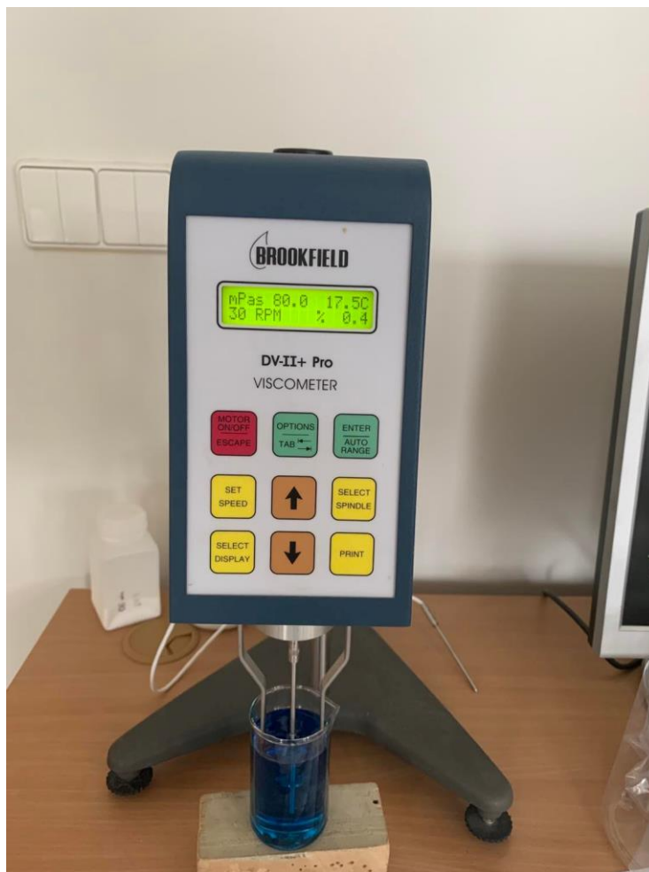
22 pav. Rotorinis skysčio klamos tyrimo stendas [asmeninis archyvas]
