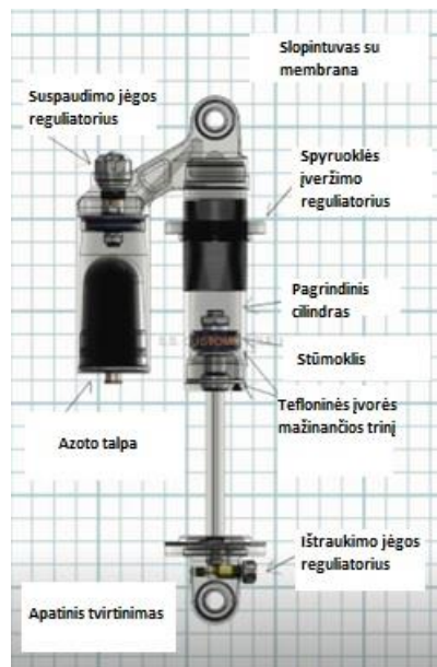
13 pav. Slopintuvo, kuriame azotas ir alyva atskirti membrana pavyzdys [17]
