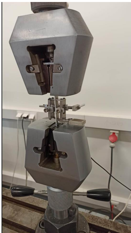
34 pav. Įtvirtintas bandinys su prijungtu ekstensiometru
