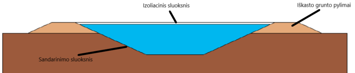
10 pav. PTES akumuliacinės talpos skerspjūvis [12]
