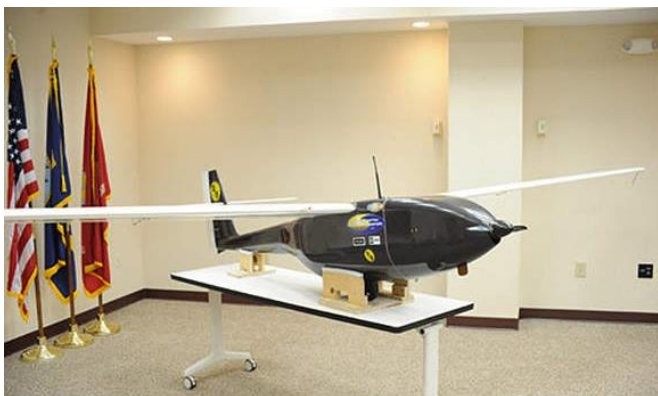
8 pav. Karinės paskirties, vandeniliu varomas „Ion Tiger“ bepilotis orlaivis [20]
