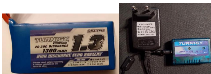
12 pav. Orlaivio komplektacijoje esanti baterija ir pakrovėjas
