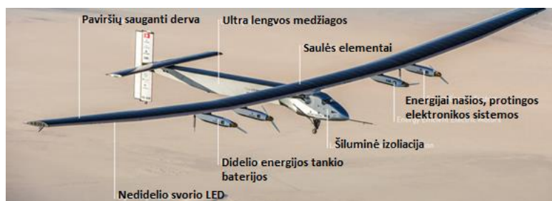
2 pav. Solar Impulse 2
