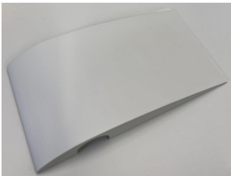
15 pav. Centrinės dalies dangtelis po mechaninio apdirbimo
