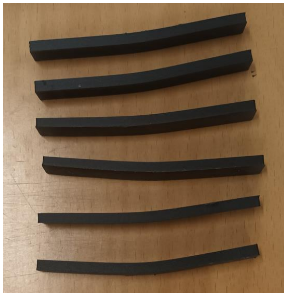
2.11 pav. 3-jų taškų lenkimo „Onyx“ bandiniai po bandymo
