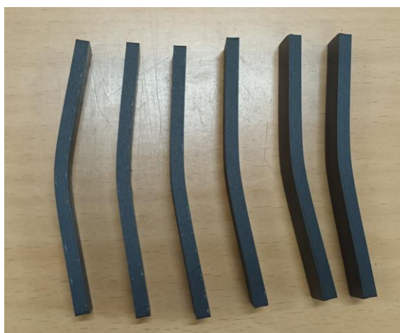
2.12 pav. 3-jų taškų lenkimo „Onyx“ + kevlaras bandiniai po bandymo
