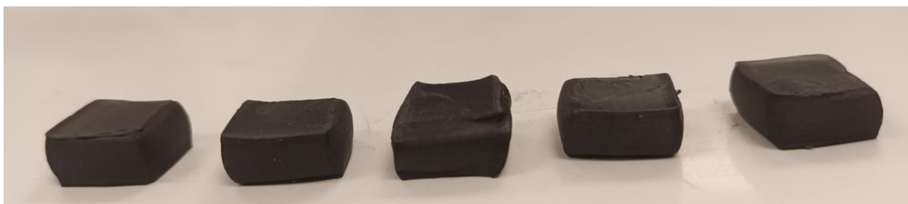
2.18 pav. Gniuždymo „Onyx“ bandinys po bandymo
