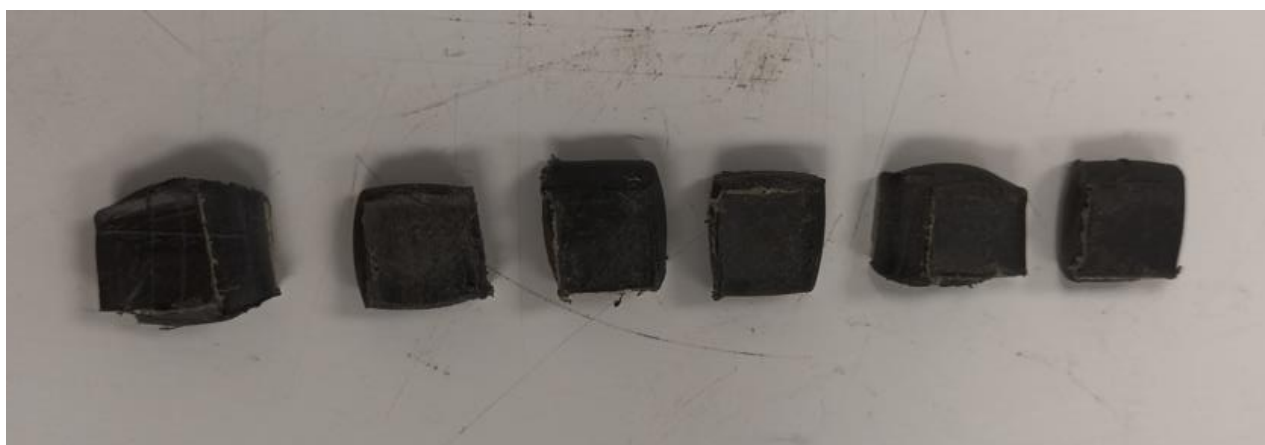
2.19 pav. Gniuždymo „Onyx“ + kevlaras bandinys po bandymo
