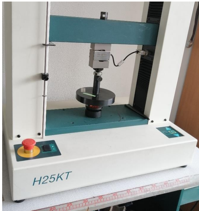
Fig. 27. Tinius Olsen H25KT testing machine
