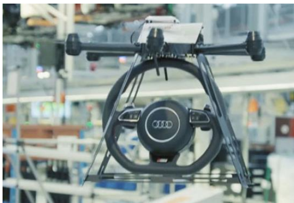
1 pav. Oro robotas – dronas naudojamas Audi fabrike dalių transportavimui (Misra et al., 2020)
