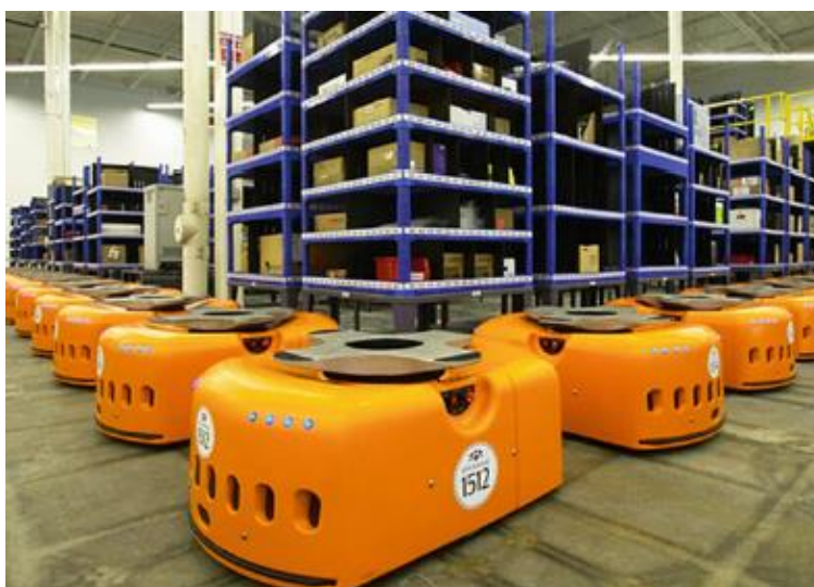
3 pav. Robotai automatizuotos transporto priemonės naudojamos sandėlio valdymui (Misra et al., 2020)
