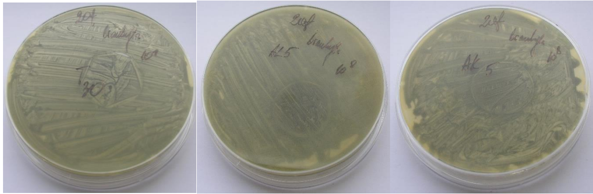
3-9 pav. Plastifikuoto DAC plėvelių su kmynų aliejumi ir linaloliu antibakterinių tyrimų difuzijos į agarą metodu rezultatai: a) kontrolė (DAC-T30); b) DAC-T25-AL5; c) DAC-T25-AK5
