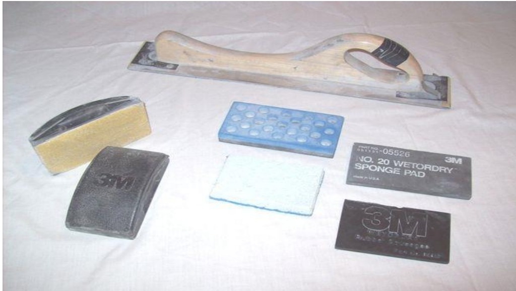
17 pav. Glaisto apdirbimui naudojami įrankiai
