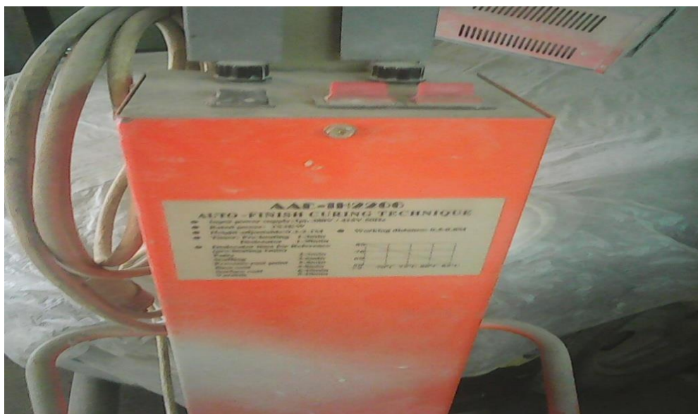
25 pav. Infraraudonųjų spindulių džiovintuvo valdymo pultas
