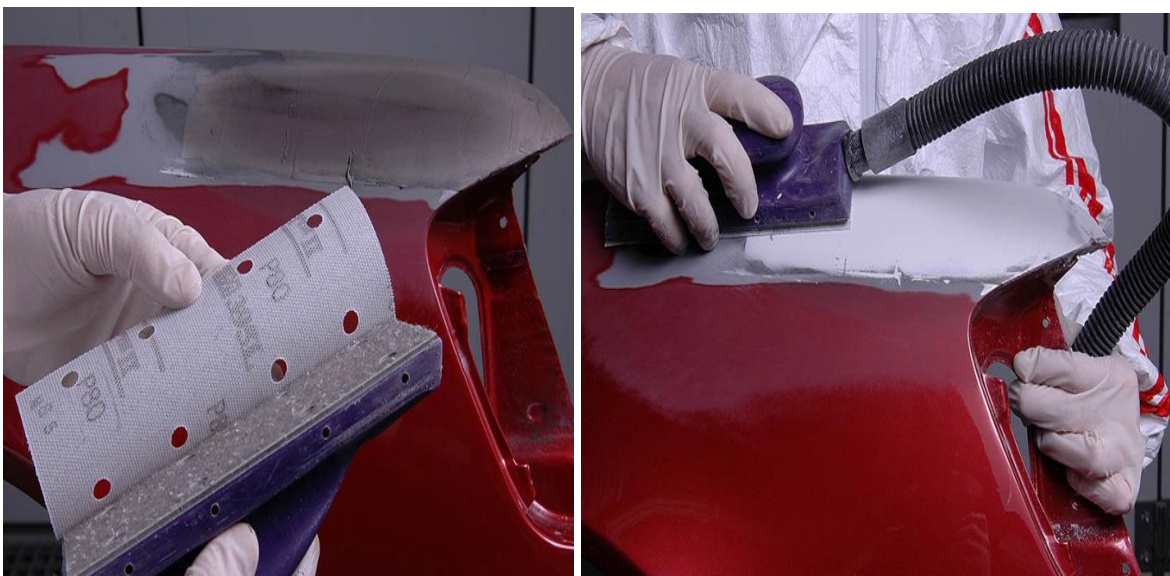
18 pav. Detalės šlifavimas abrazyviniu lakštu P 80 .
