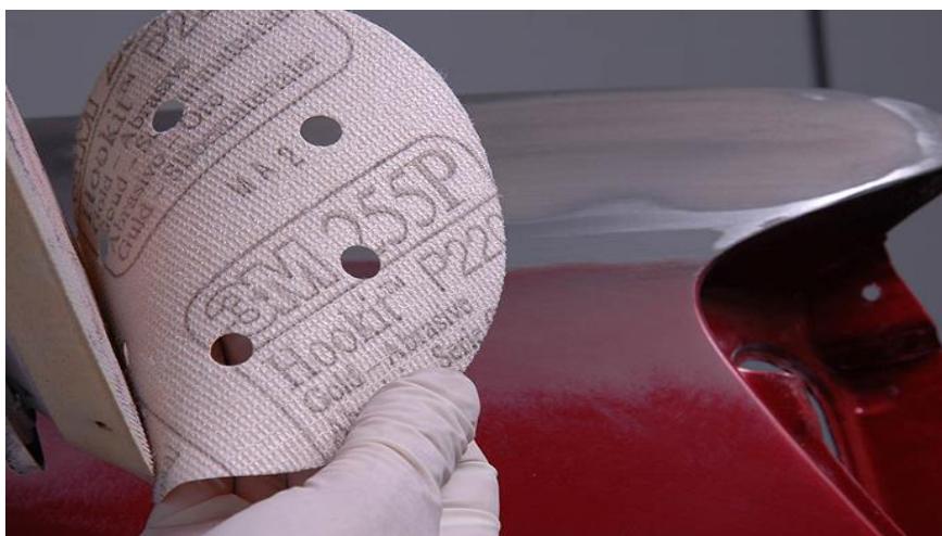
20 pav. Detalės šlifavimas abrazyviniu disku P 220.
