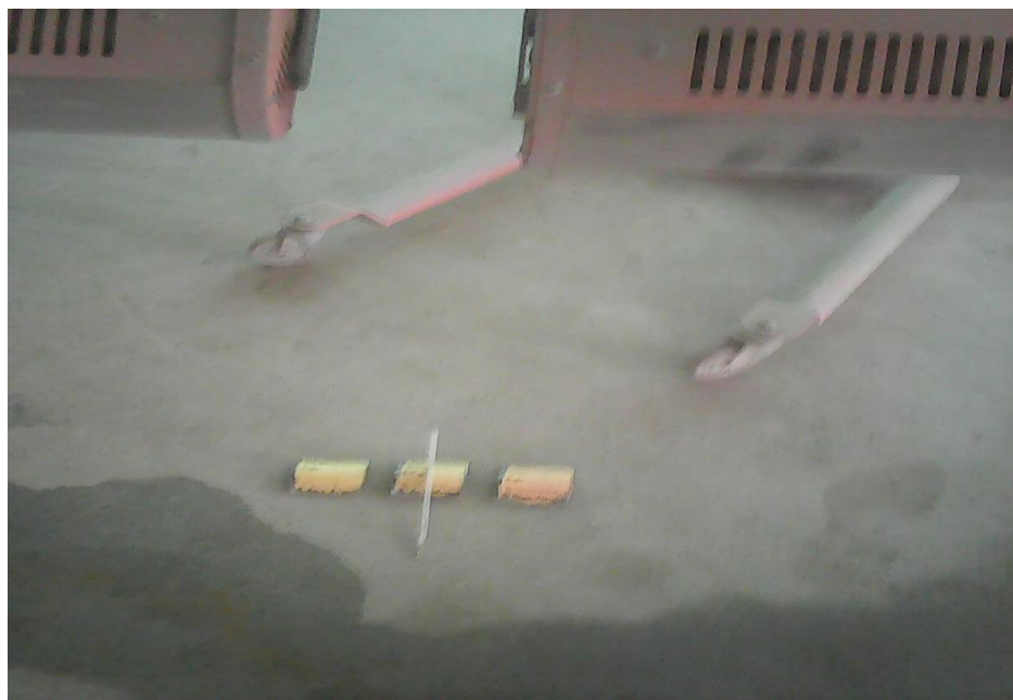
28 pav. Trys bandiniai džiovinami 60 laipsnių temperatūroje kur į 100 g glaistą įdėta (1, 2.5, 4 g ) kietiklio.
