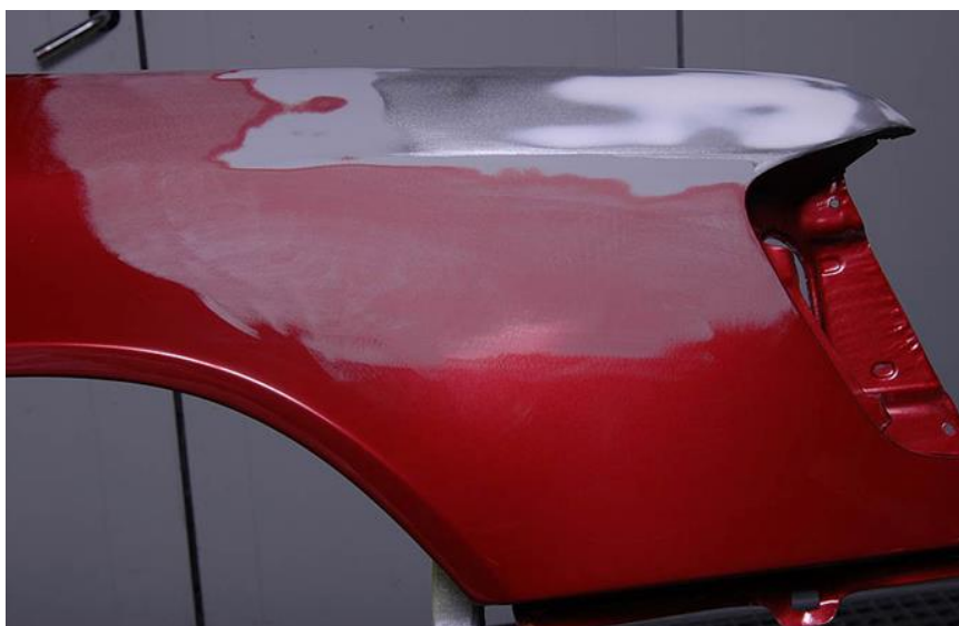
21 pav. Detalė paruošta gruntavimui.
