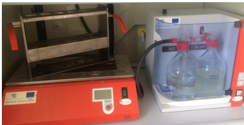
8 pav. Kjeldalio mineralizavimo blokas (Labor-Technik GmbH - Vokietija)
