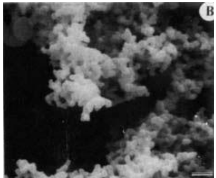
b) gelio mikrostruktūra po sutraukos pjaustymo proceso
