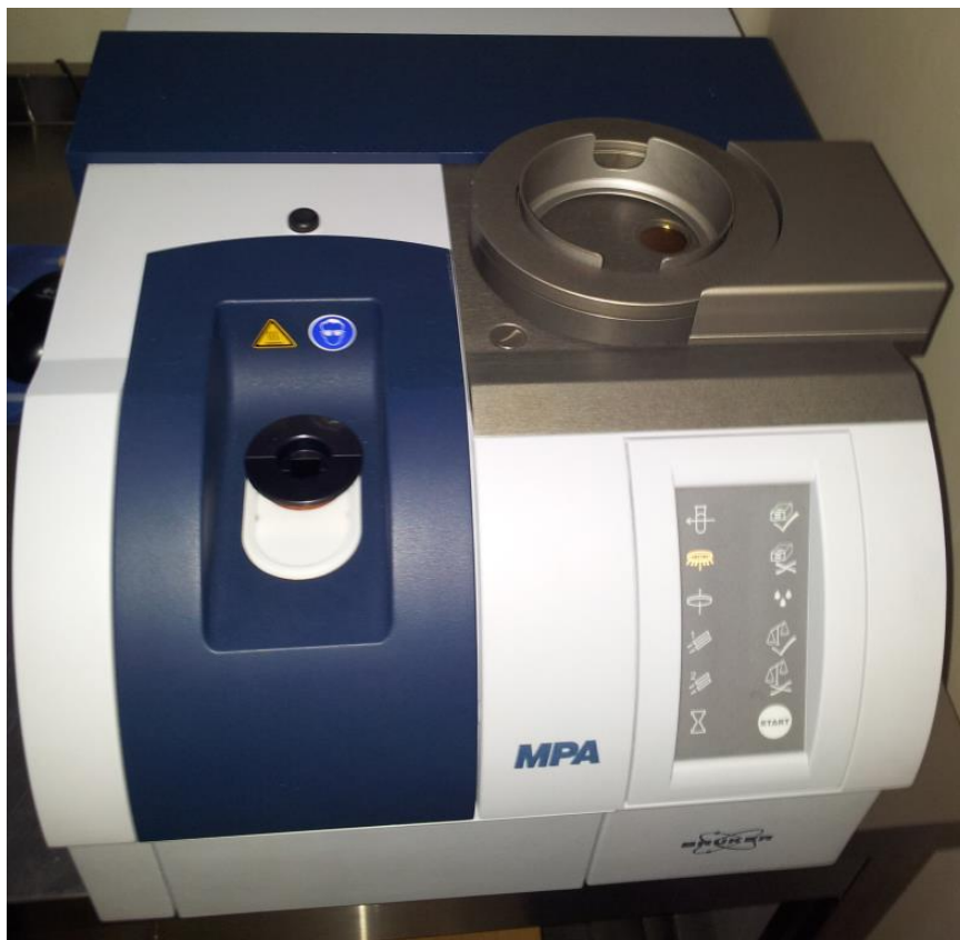
13 pav. FT – NIR MPA™ spektrofotometras (Bruker optika, Vokietija)
