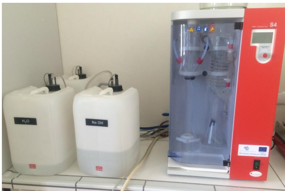
9 pav. Distiliaviavimo blokas Unit S4 (Labor-Technik GmbH - Vokietija)
