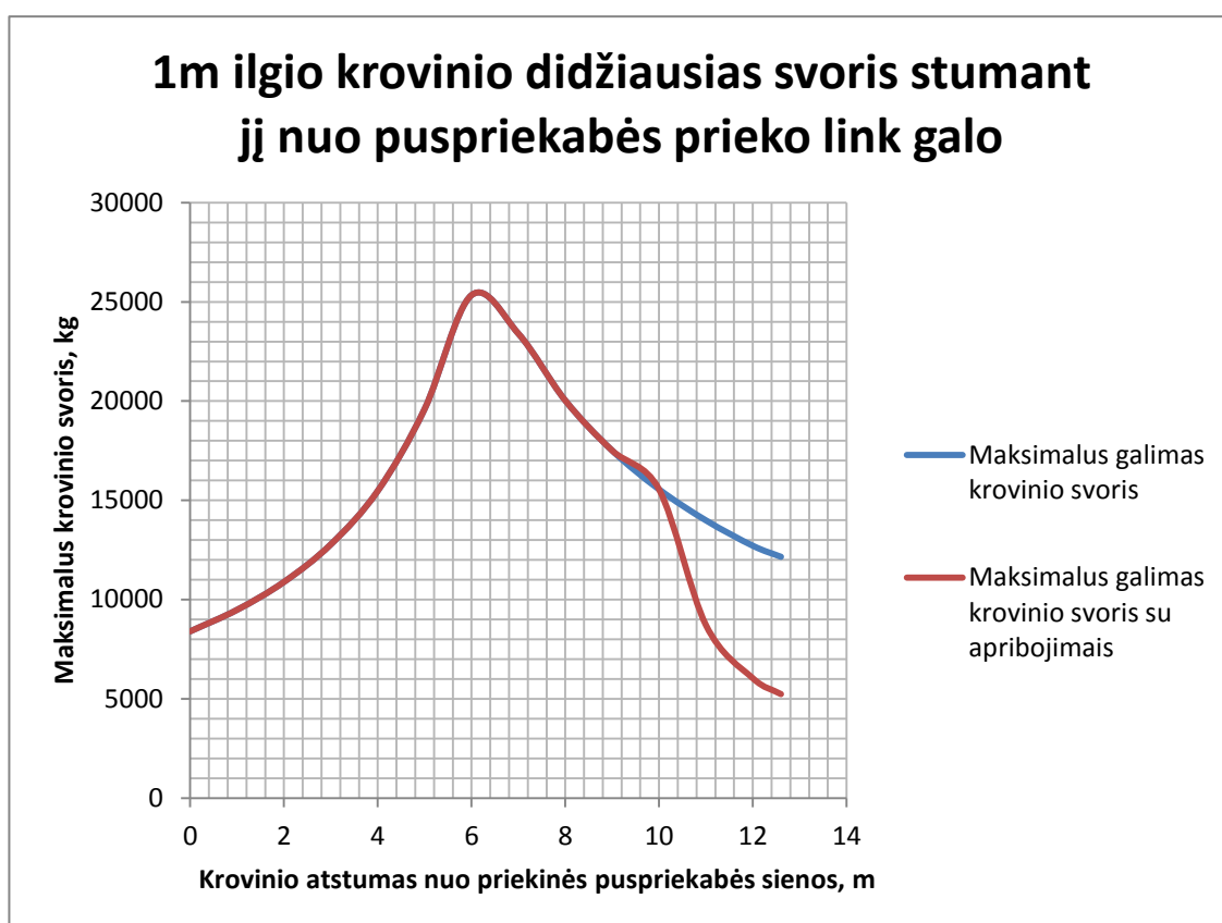
2.23 pav. 1m ilgio krovinio didžiausias svoris stumiant jį nuo puspriekabės priekio link galo
