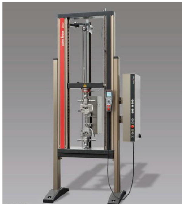
2.2 pav. Bandinių tempimo mašina ZWICK Z005 [14].
