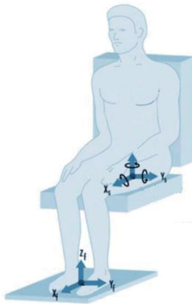
3.3 pav. Visą kūną veikiančios vibracijos matavimo ašys [23]
