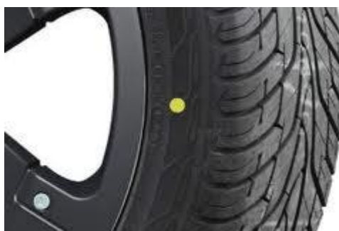
1.13 pav. Padangų lengviausios ir sunkiausios vietos žymėjimas.
