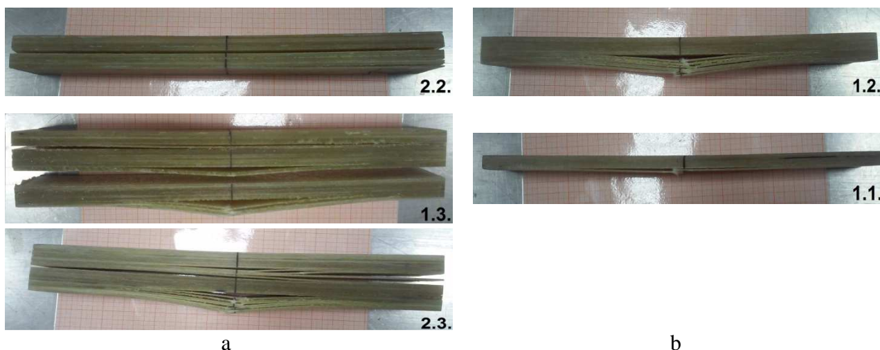
2.10 pav. Sijos po mechaninių charakteristikų nustatymo bandymų. a – sijų trūkis ties centru; b – tempiamų sijos sluoksnių trūkimas
