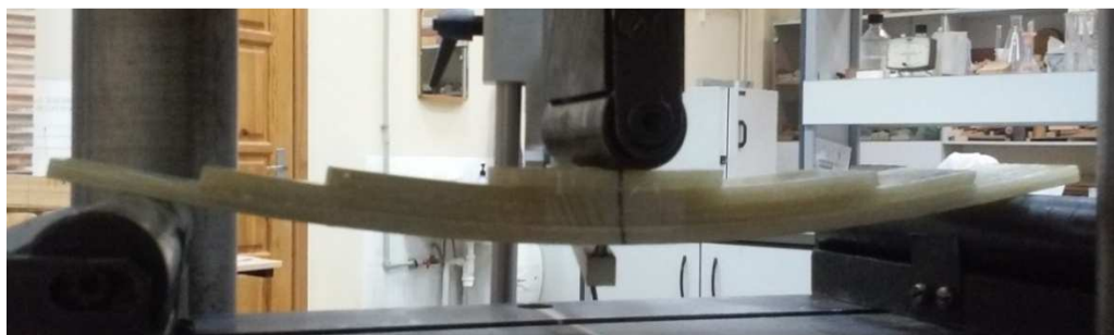
3.5. pav. Stiklo plastiko linskės bandinio 3.1. lenkimo bandymas
