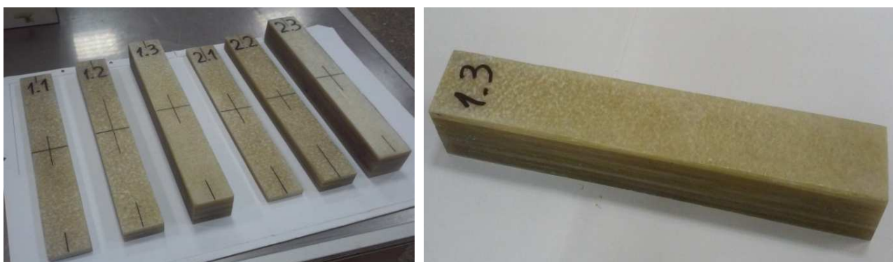
2.7 pav. Nušlifotos, lenkimo bandymui paruoštos sijos/bandiniai
