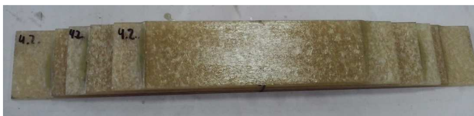
3.9. pav. Tepalu suteptas bandinio 4.2_K1 paviršius (matomas suteptas viršutinis 3-o lakšto paviršius)
