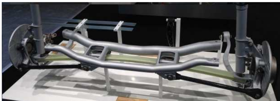
1.11 pav. Kompanijos „ZF“ pristatyta galinės ašies konstrukcija lengviems automobiliams [31]
