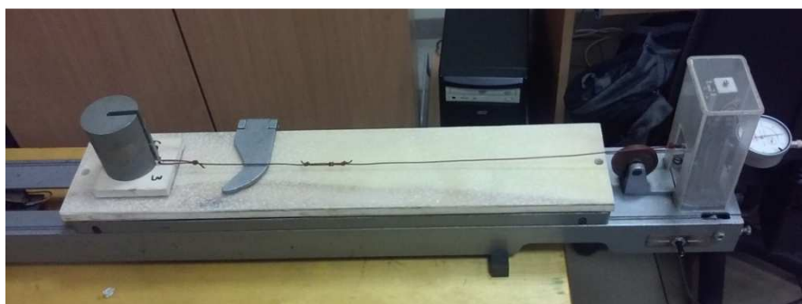
2.12 pav. Trinties koeficiento nustatymo stendas su stiklo plastiko plokšte ir bandiniu
