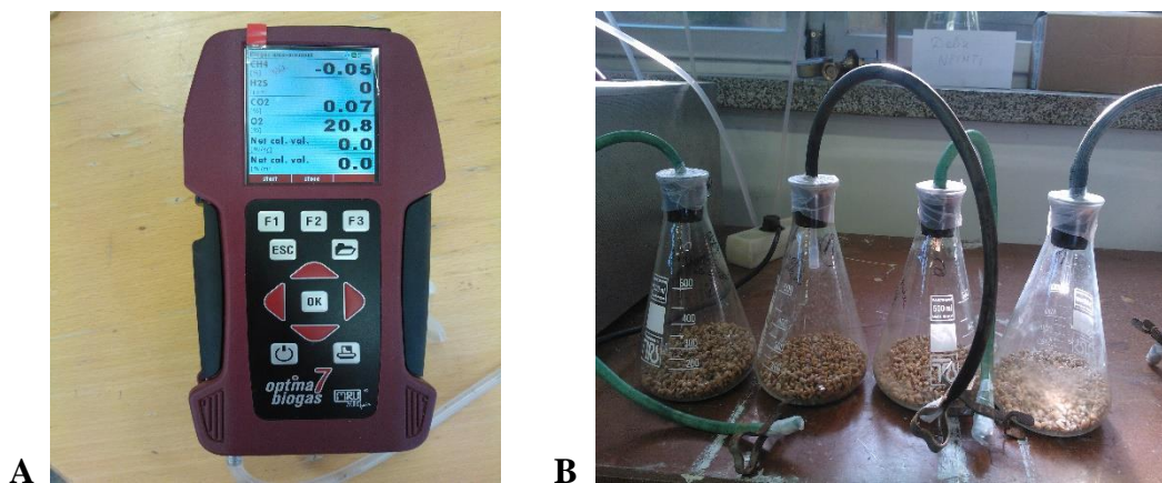
2.2 pav. „OPTIMA BIOGAS” dujų analizatorius (A) ir talpyklose laikomi kviečių grūdai (B)
