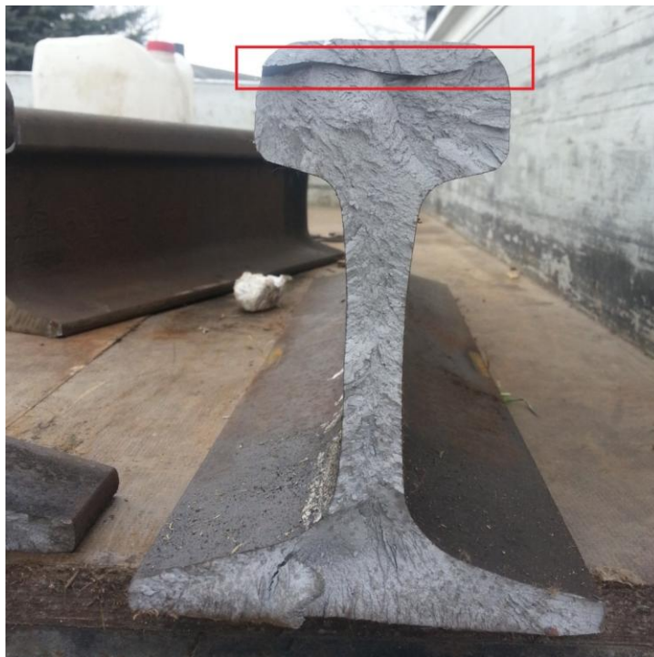
16 pav. 31-mo kodo defektas[6].
