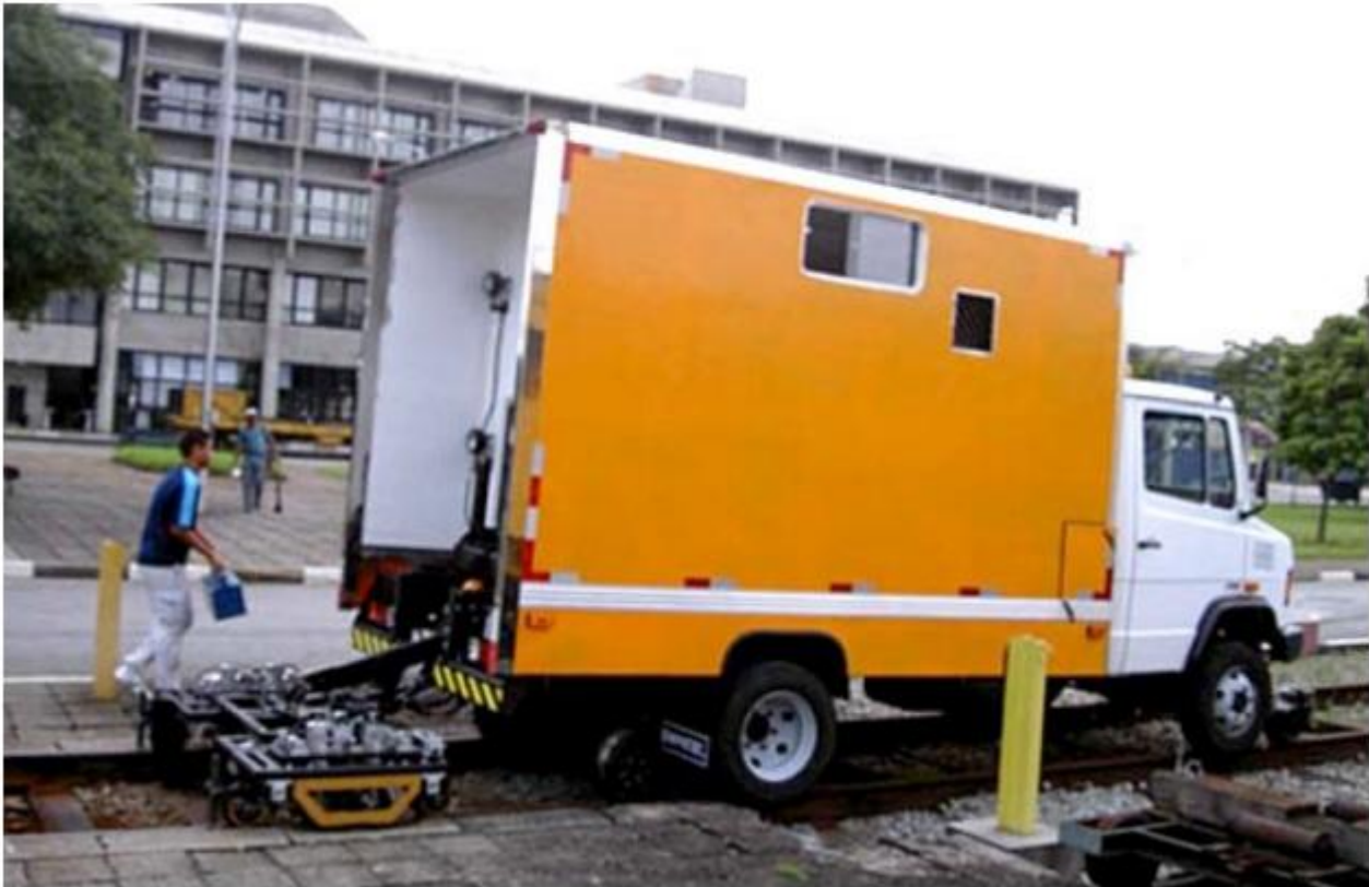
4 pav. Bėgių testavimas su DIO 2000 sistema [9]
