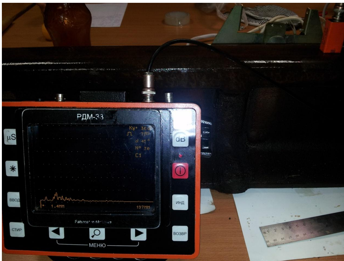
22 pav. Defektoskopo rodmenys atliekant bandymą su 45°keitikliu, 28dB diapazone [6]
