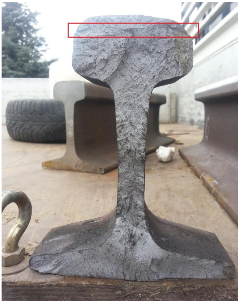
17 pav. 31-mos grupės defektas [6].
