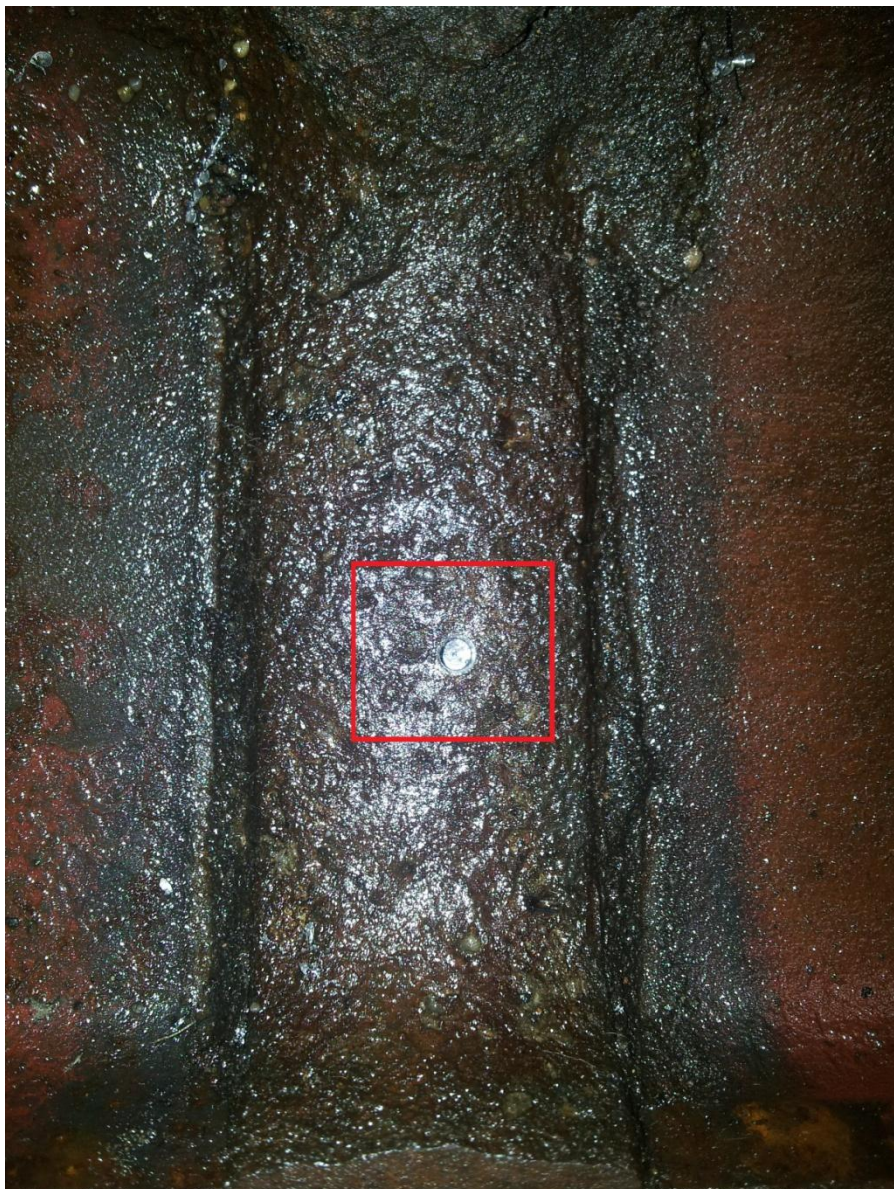
19 pav. Dirbtinai padarytas defektas termitinėje sandūroje [6]
