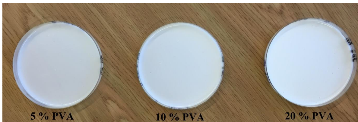
9 pav. Plėvelės iš Kollotex krakmolo su skirtingu PVA priedu
