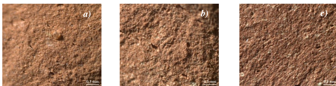
17 pav. Girininkų molio keraminės šukės, degtos 4 h 800 (a), 1025 (b) ir 1050 (c) °C temperatūrose, optinio mikroskopo nuotraukos (didinimas 75 kartai)
