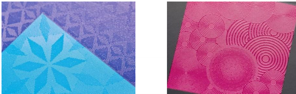
9 pav. Mikro reljefą formuojantis UV lakas [9]
