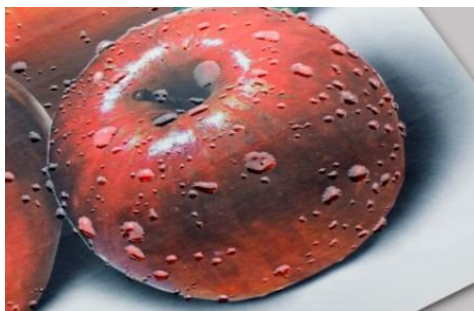
7 pav. Iškilusio UV lako pavyzdys – vandens lašelių efektas [9]
