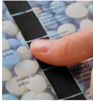
13 pav. Šiluma paveikiamas UV lakas [9]
