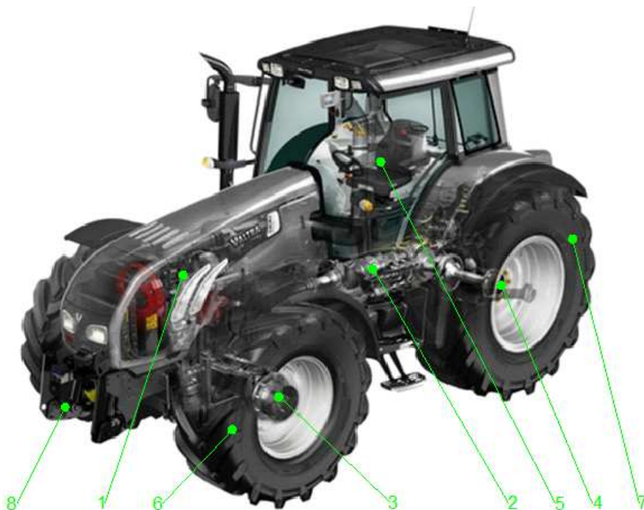
1.1 pav. Traktoriaus sandara: 1 variklis, 2 transmisija, 3 priekinis tiltas, 4 galinis tiltas, 5 kabina (valdymo įtaisai), 6 priekiniai kreipiantieji (varantieji) ratai, 7 galiniai varantieji ratai, 8 priekinis prikabinimo įtaisas (atitinkamai yra ir gale).
