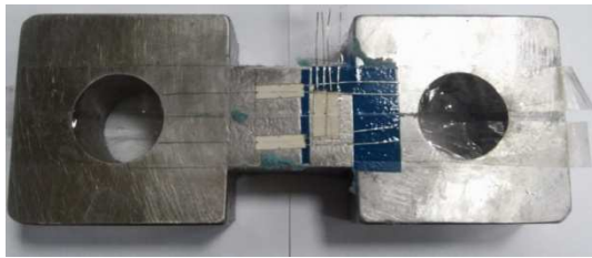
2.10 pav. Keitiklis su priklijuotais tenzorezistoriais.
