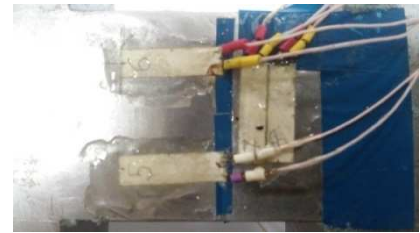
2.10 pav. Keitiklis su priklijuotais tenzorezistoriais.
