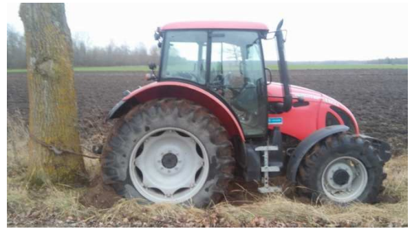
2.8 pav. Keitiklio stiprumo tikrinimas su traktoriumi : 1 - trosas, 2,3 – kaiščiai, 4 – keitiklis.
