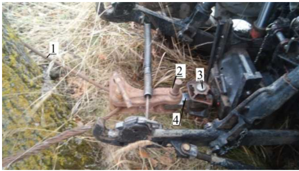
2.8 pav. Keitiklio stiprumo tikrinimas su traktoriumi : 1 - trosas, 2,3 – kaiščiai, 4 – keitiklis.
