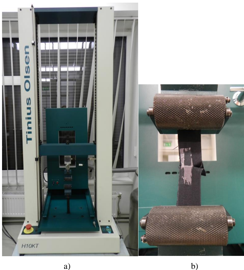
3.4 pav. a) Tempimo mašina Tinius Olsen H10 KT b) tempimo mašinos spraustuvai su bandiniu.
