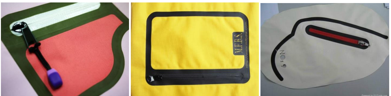
2.2.4 pav. Priklijuotos uždėtinės kišenės su užtrauktuku vaizdai [35, 36]
