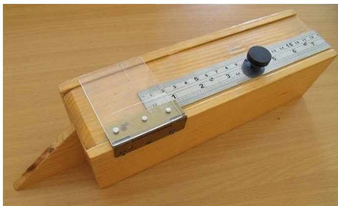
2.2 pav. Stovas medžiagų lenkiamajam standžiui nustatyti
