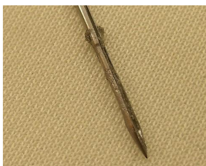
3.2 pav. Polimerinės apnašos ant siuvimo adatos
