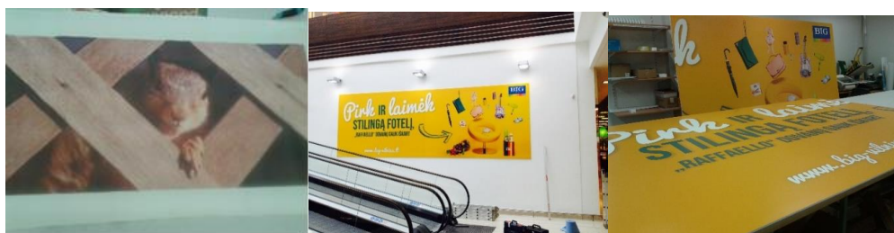
6 pav. a) Ant drobės atspausdintas gaminytis b) Atspausdinta ant lipnios plėvelės c) Ant PVC plokštės užklijuota iškaba
